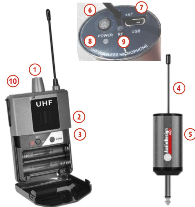
**Se si desidera cambiare la frequenza di trasmissione, agire sui pulsanti «up» e «down» per aumentare o diminuire la frequenza. Il ricevitore si sincronizzerà automaticamente.**
