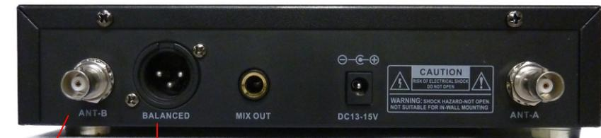
CONNETTORE ANTENNA B RICEVITORE 2
